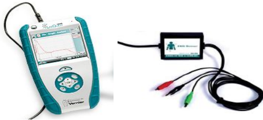
〈그림 6〉 MBL 장비인 LABQUEST와 심전도 센서인 EKG-BTA
